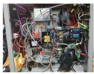
Ho diviso in due la scatola (sopra e sotto), sopra tutta la parte RF e sotto tutta la parte USB e alimentazioni. Ho poi posizionato Adalm Pluto chiudendolo all'interno di un guscio metallico al fine di proteggerlo da eventuali disturbi degli stadi di alimentazione switching.
